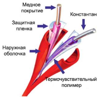
Интеллектуальный термокабель серии СТІ незаменим в проектах, где возможен риск ложного срабатывания из-за повреждения термокабеля.
