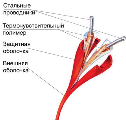
**Извещатель пожарный линейный тепловой** (термокабель) позволяет обнаружить источник перегрева в любом месте на всем его протяжении. Термокабель представляет собой единый датчик непрерывного действия и применяется в тех случаях, когда условия эксплуатации не допускают установку и использование обычных извещателей, в том числе и в условиях повышенной взрывоопасности применение термокабеля является во многих случаях оптимальным решением.
