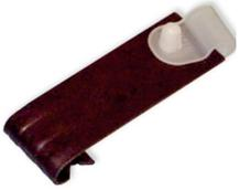
Монтажные зажимы модели CC-2N для крепления извещателя к кабельному лотку состоят из стального зажима типа "Caddy", держателя типа WAW-N и кнопочной защелки. Данные зажимы предназначены для крепления линейного теплового извещателя по бокам кабельного лотка. Рекомендуется устанавливать термокабель в виде синусоидальной волны.
