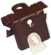
Монтажные зажимы модели CC-10 похожи на модель CC-2N, однако они используют другие типы зажимов "Caddy". Зажимы CC-10 предназначены для толщины материала до 12,7 мм и могут фиксироваться на месте через одно из монтажных резьбовых отверстий.
