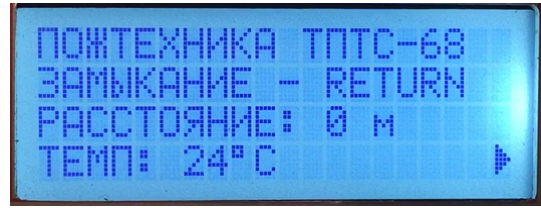
Сообщение о коротком замыкании в обратной цепи (для Класса А)
