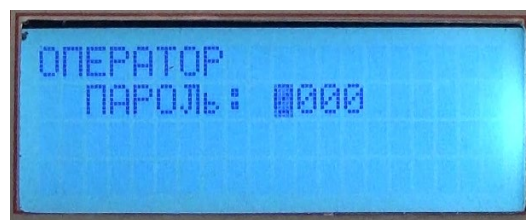
Окно установки пароля оператора
