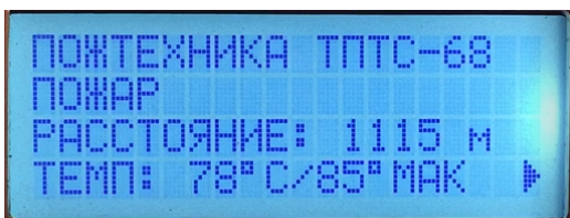
Экран режима «ПОЖАР» с повышением температуры
