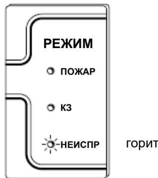
**Шаг 2. Проверка контроля короткого замыкания**
