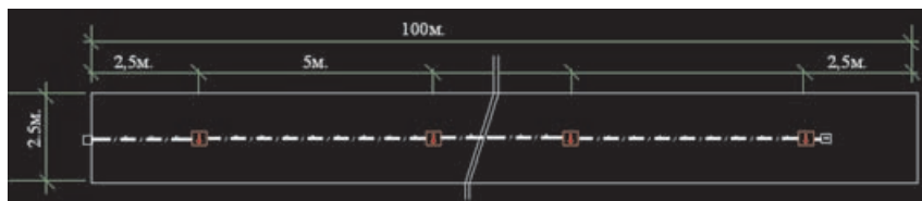
Рис. 4. Защита кабельного коллектора с применением точечных извещателей.
